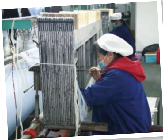
永旭晟 YXS-A 型自动穿经机穿纱速度最高可达 140 根 / 分钟。
