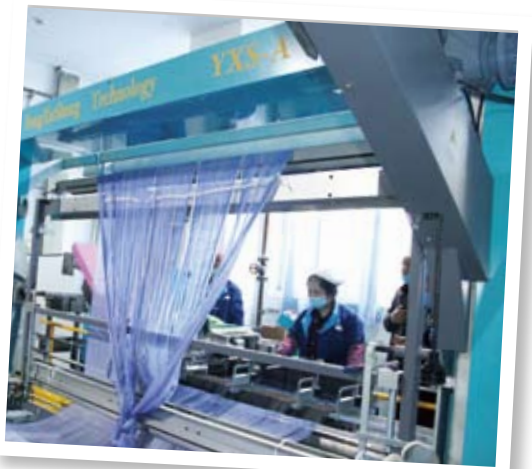
厂房里作业中的 YXS-A 型自动穿经机。
