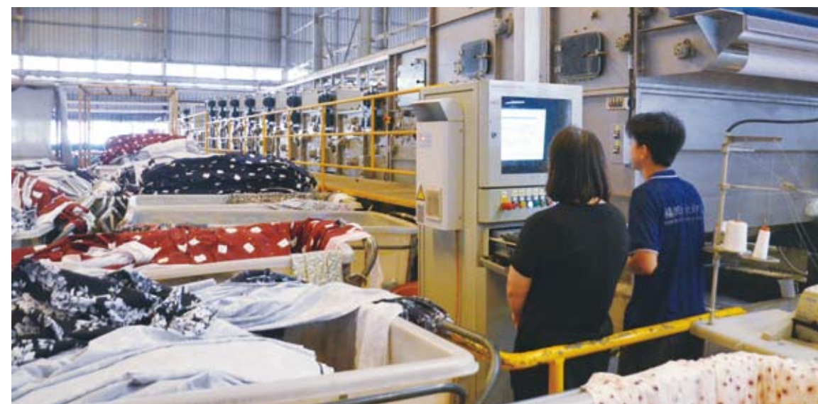
印花针织物低张力平幅连续水洗关键技术节水、节能，提高生产效率，实现了废水的循环净化处理及回用。
